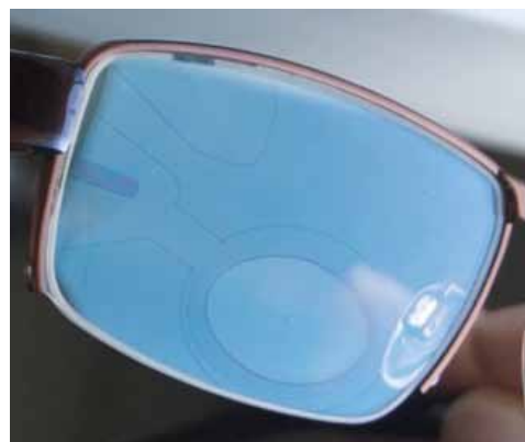
Abbildung 3: Hybrid-Glas: Elliptisches Nahteil mit Struktur einer Fresnel-Linse (gekreuzte Polarisatoren)
